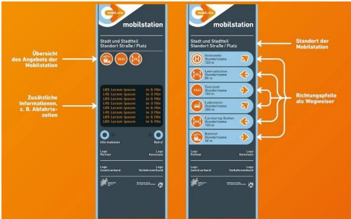
Abb. 2: Aufbau einer Informationsstele
